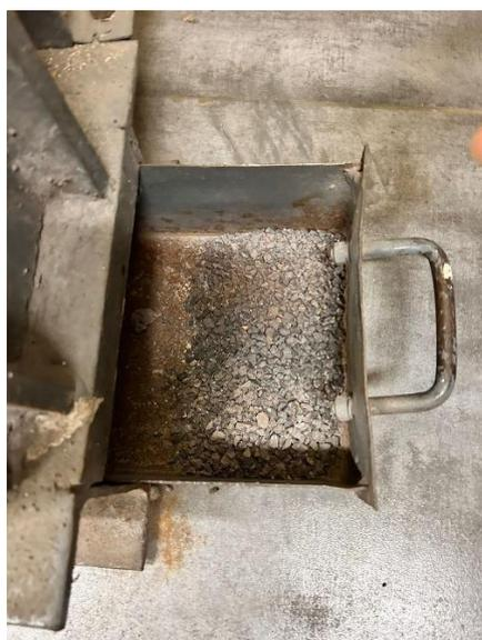
Рисунок 5 – Руда после дробилки
